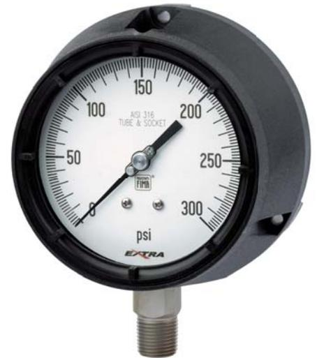
Instrumentos de acordo com as prescrições construtiva e de segurança pela norma ASME B40.1, UNI-EN 837-2.
